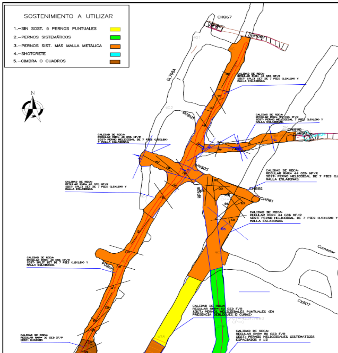
Figura 7- Mapeo geomecanico de la GL798N/S
