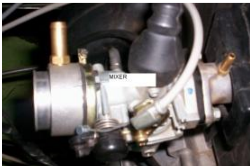
Figura N° 16: En esta fotografía se señala el mezclador como Mixer
