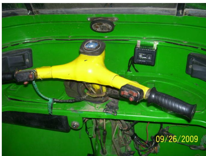
Figura N° 18: Correcta instalación del conmutador en Mototaxi
