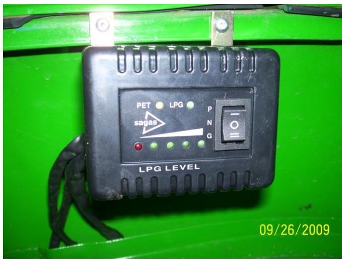
Figura N° 18: Correcta instalación del conmutador en Mototaxi
