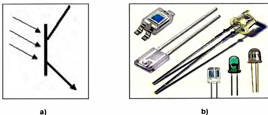
Figura 3.16 El fototransistor a) símbolo b) diversos tipos de forma
