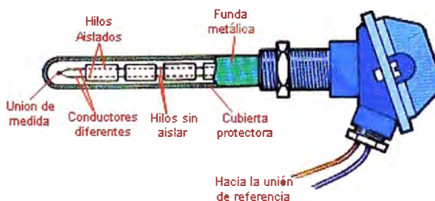
Figura 2.8. Diagrama esquemático de un termopar Fuente: http://sensoresdetemperatura.blogspot.com/2009/05/sensores-de-temperatura.html
