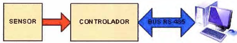
Figura 4.5. Uso del bus RS-485 para comunicación con una computadora Fuente: Diseño propio
