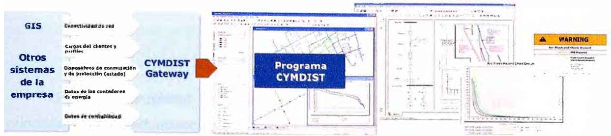
Figura 6.4 Integración del Programa de Flujo de Carga con el GIS
