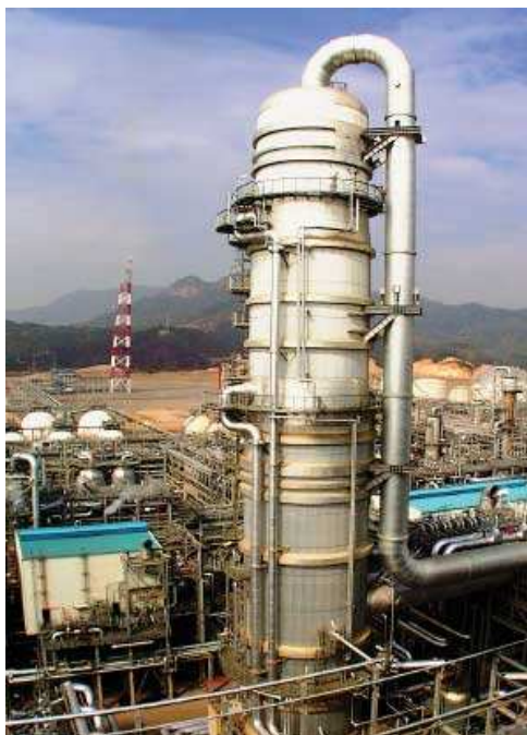
Gráfico 58. Torre de Quench-oil, un elemento clave en los actuales megacrackers (1000+ TMA).
