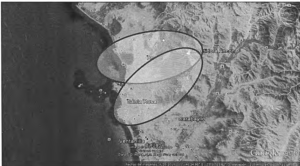
Figura 3.9 Ubicación de retransmisora Ancon y diagrama de cobertura. Fuente: Google earth
