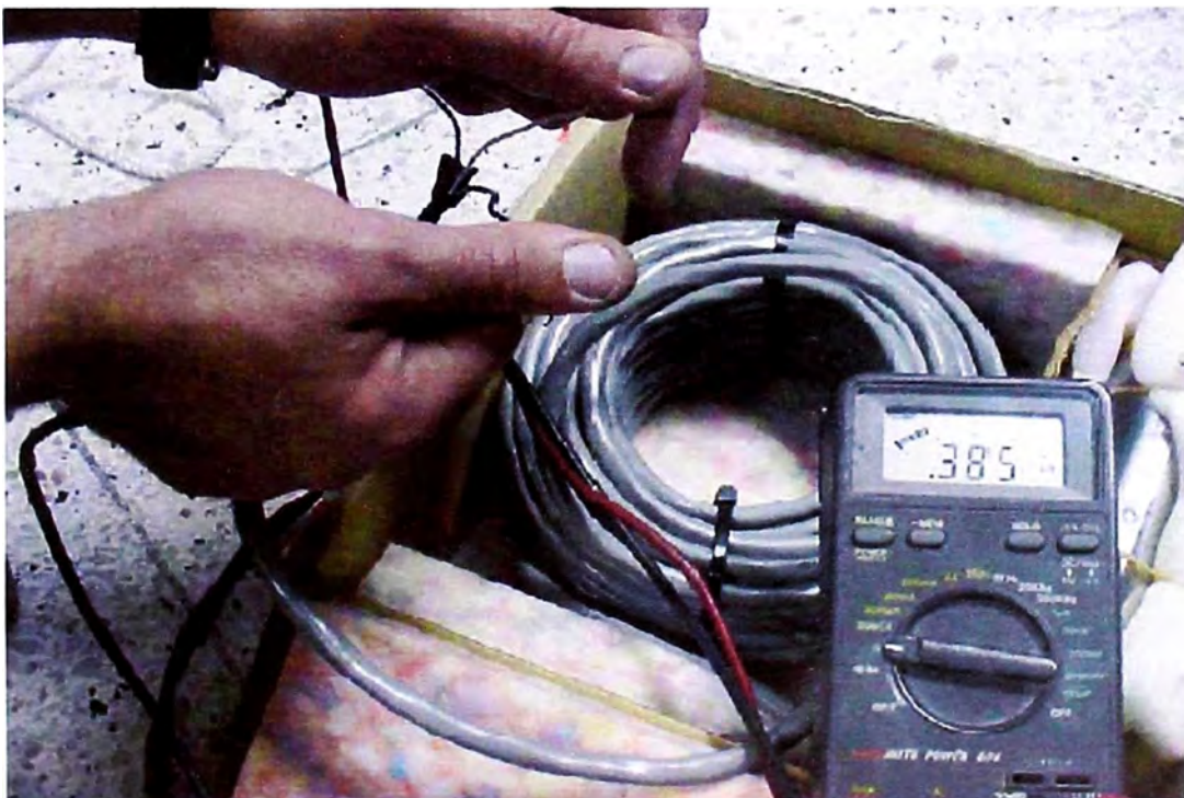
Figura 3.3. Resistencia en terminales del geófono
