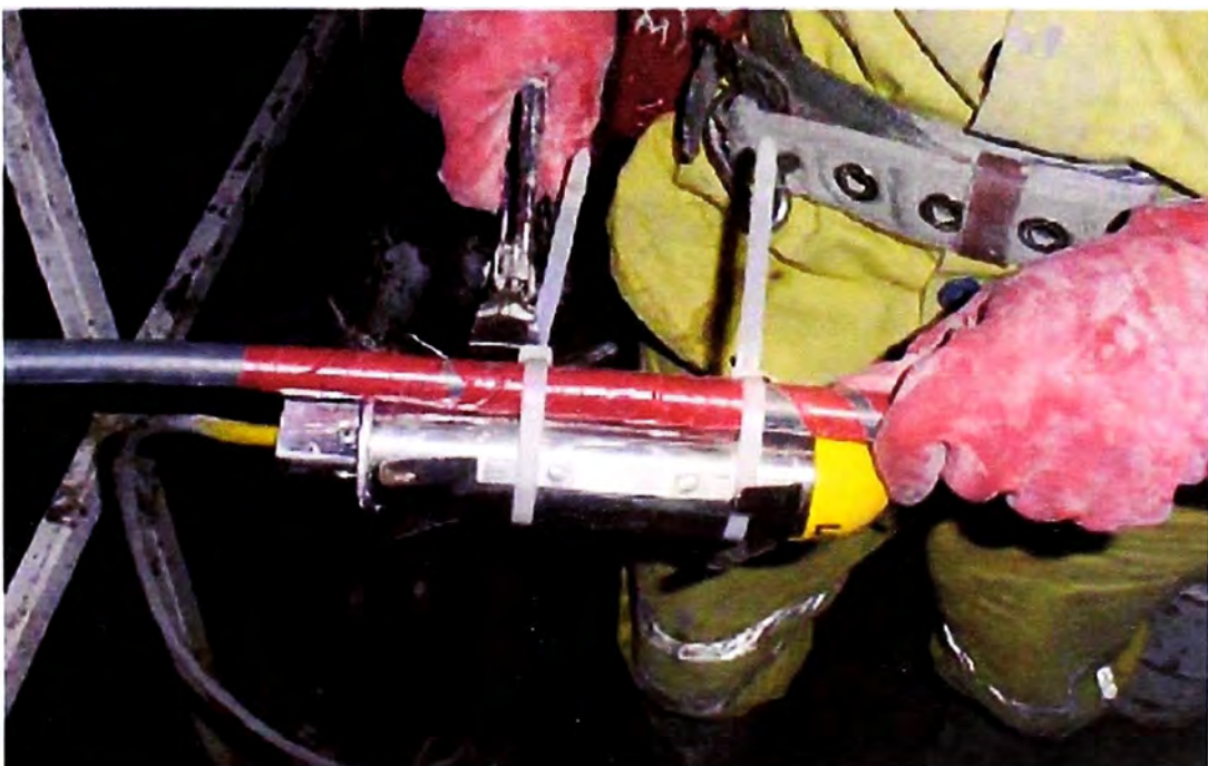
Figura 3.5. Aseguramiento del geófono con la tubería.
