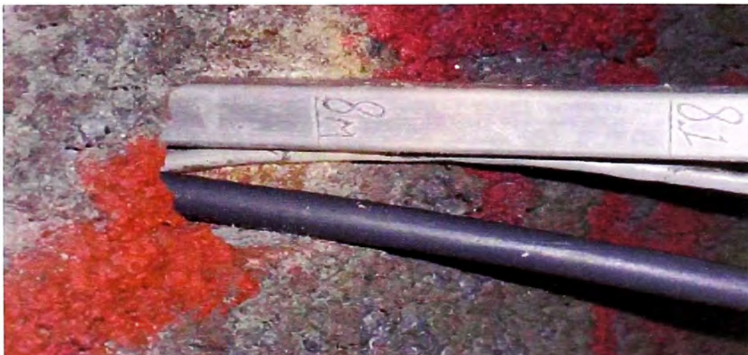
Figura 3.7. Inserción del geófono con la varilla
