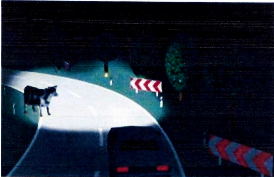
Figura 3.13 Iluminación con viraje dinámico (AFS)
