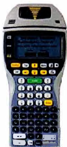
Fig. 1.16 Lector de mano de corto alcance que opera a la frecuencia de 900 MHz.
