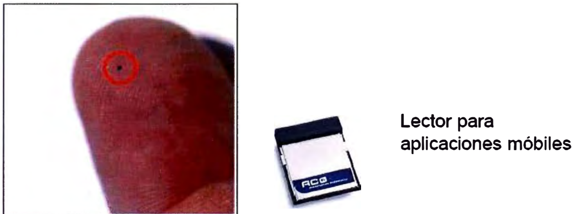
Fig. 1.36 Microchip RFID vs. tamaño del dedo y lector RFID pasiva.
