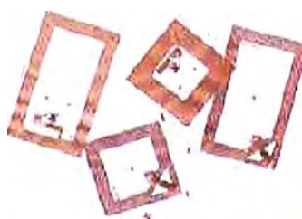
Fig. 4.3 Tags RFID en frecuencias de UHF y HF.
