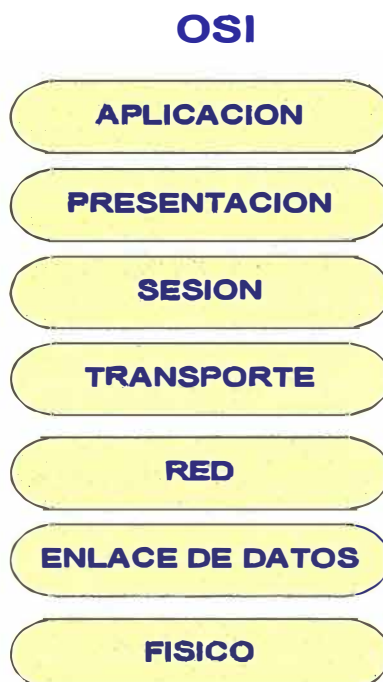
Figura 1.1 Modelo de referencia OSI (Fuente: Propio)
