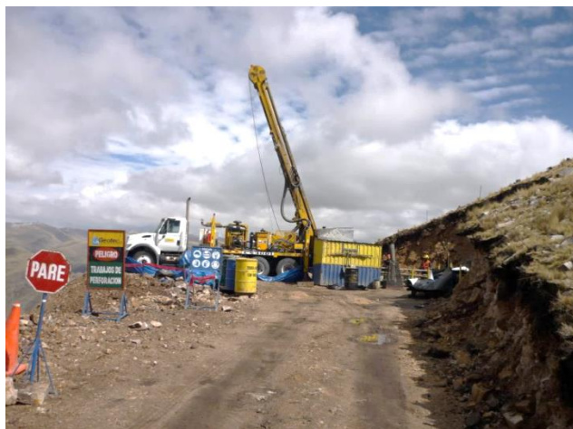
Figura 01: “Perforación Diamantina - Máquina CS-3001”
