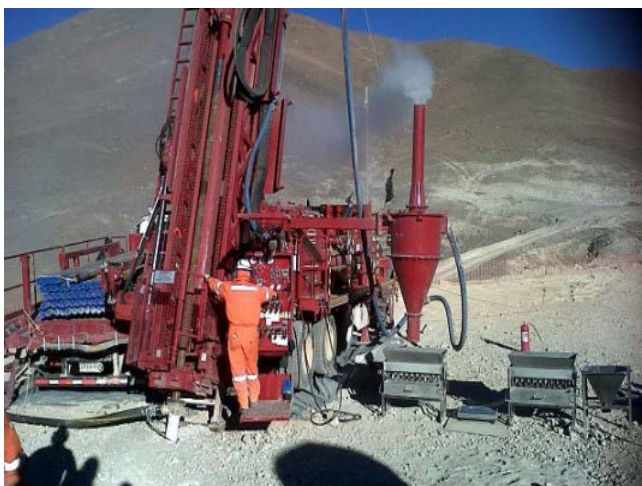
Figura 02: "Perforación Aire Reverso – Máquina Schramm
