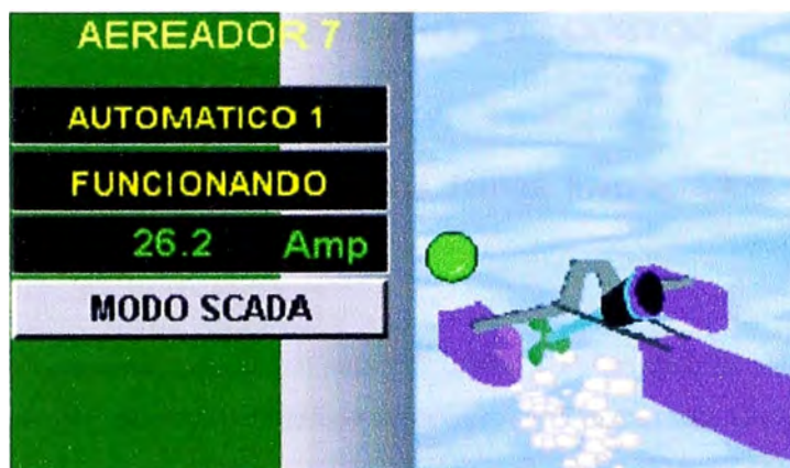
Figura 4.8 Aireador en SCADA (Fuente: SCADA)
