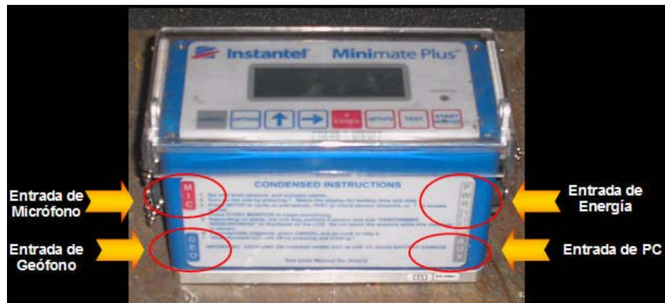
Figura 1.10 Equipo Minimate Plus - InstanTel
