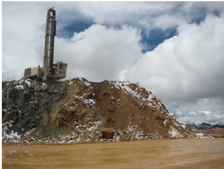
Figura 09. Aquí puede verse el contacto entre el material mineral y desmonte. (Fuente propia)
