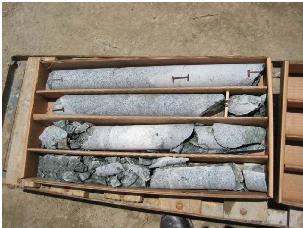
Figura 18. Caja de testigos recuperada de las perforaciones diamantinas. (Fuente propia)
