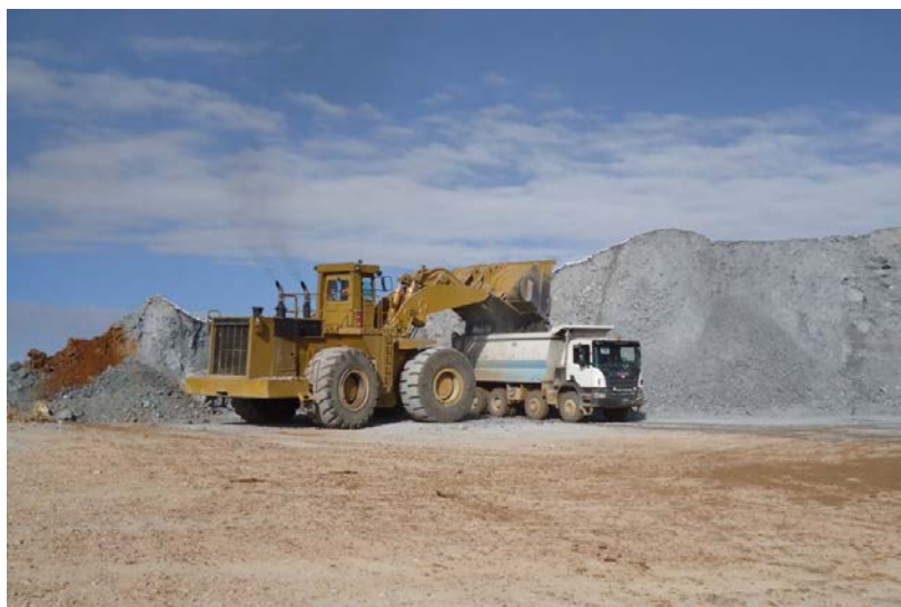
Figura 12. Aquí puede verse un equipo de carguío, un cargador frontal 992 cargando un volquete de 20m3 con material desmonte. (Fuente propia)
