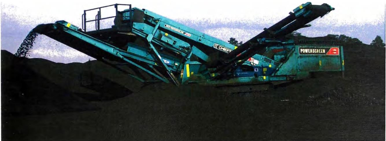
*Figura 10: Clasificador de Carbón "Powerscreen Chieftain 400" con capacidad de lavado
