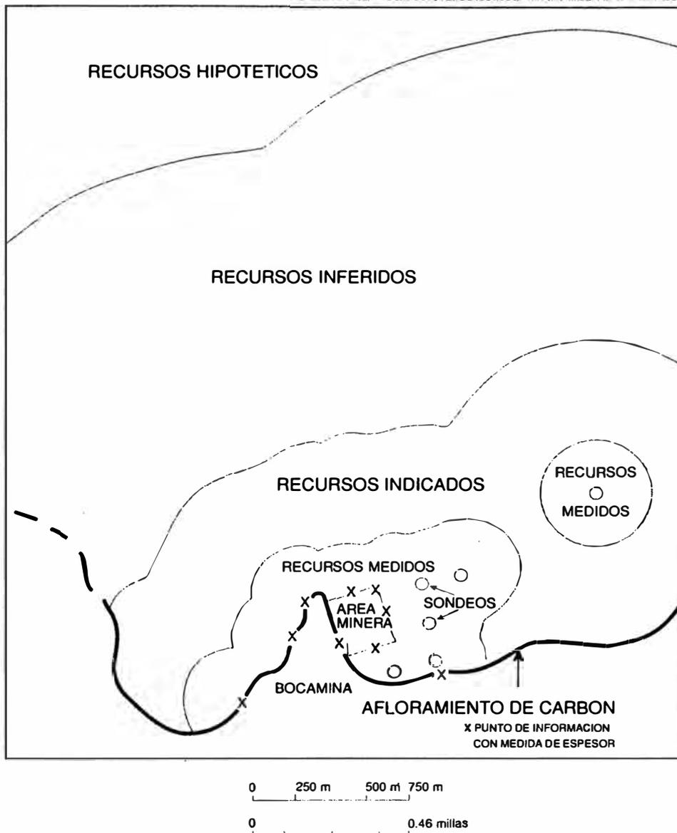
Definición de las áreas de confiabilidad de los recursos a partir de puntos de medición sobre el afloramiento, complementados por datos provenientes de una mina y varios sondeos.
