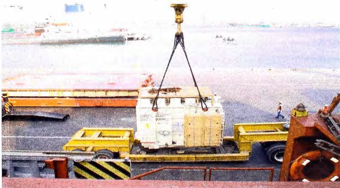
Figura 5.16 Descarga del Buque – Modular (Fuente: Instructivo SIEMENS Colombia, Servicio Técnico SAT/MA 103.01 Transformadores de Potencia)
