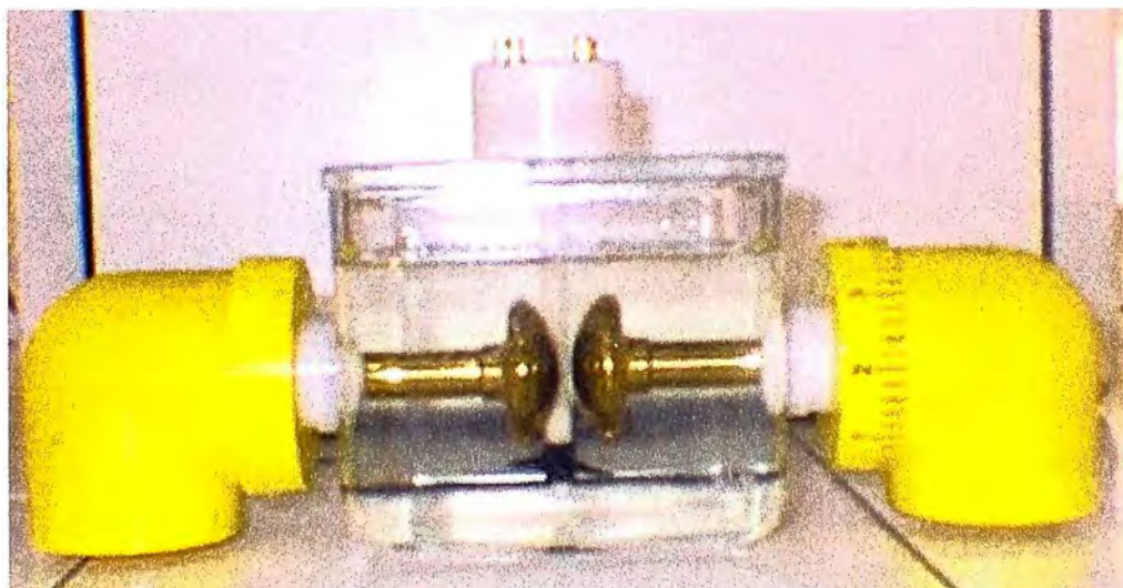
Figura 4.5 Prueba de Rigidez Dieléctrica del aceite (Fuente: Laboratorio de Prueba de Materiales, Fábrica de Transformadores de Siemens en Nüremberg)
