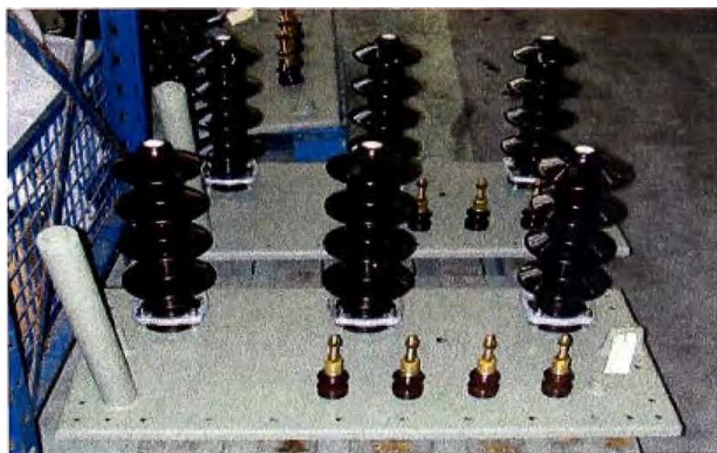
Figura 2.7 Pasatapa Tipo Seco (Fuente: Presentación Fábrica de Transformadores de Potencia – SIEMENS-2002 )
