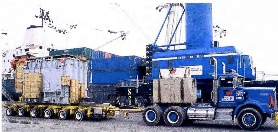
Figura 5.16 Descarga del Buque – Modular (Fuente: Instructivo SIEMENS Colombia, Servicio Técnico SAT/MA 103.01 Transformadores de Potencia)
