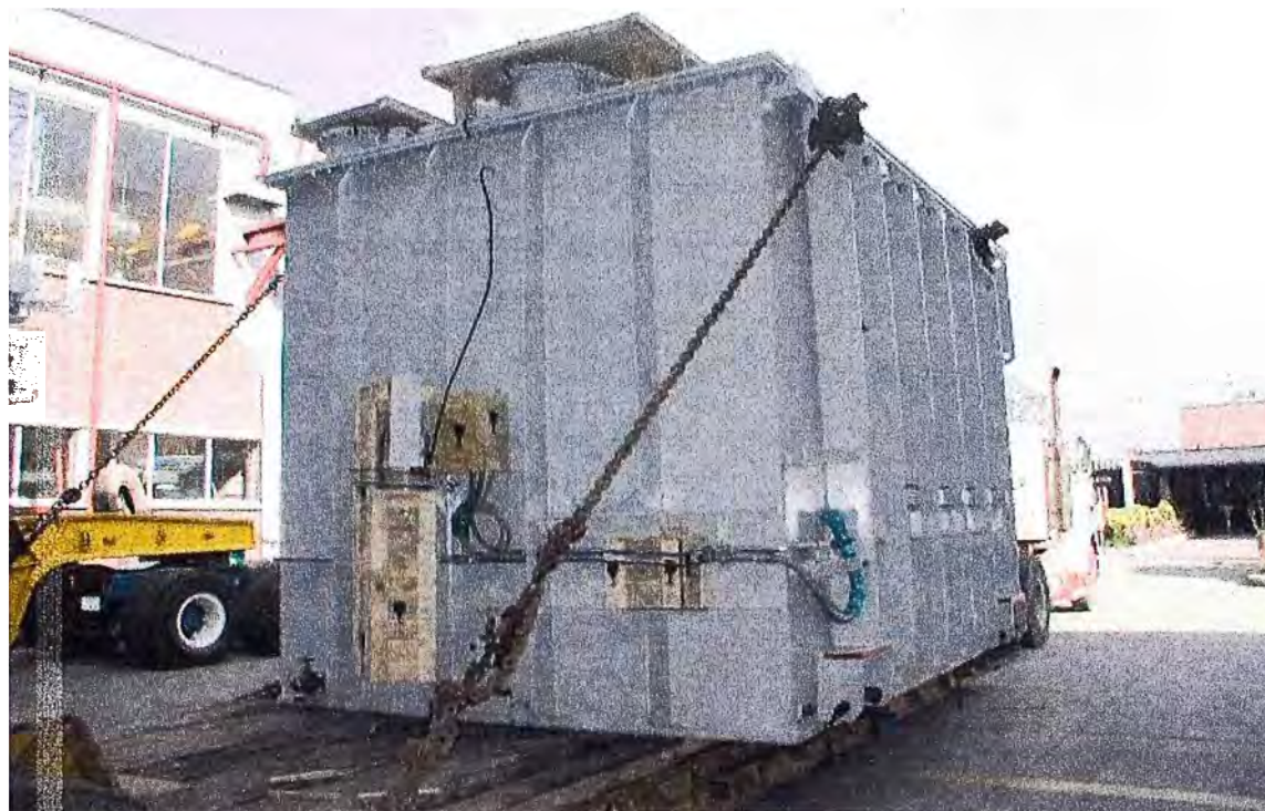
Figura 5.18 Aseguramiento para Transporte (Fuente: Instructivo SIEMENS Colombia, Servicio Técnico SATYMA 103.01 Transformadores de Potencia)
