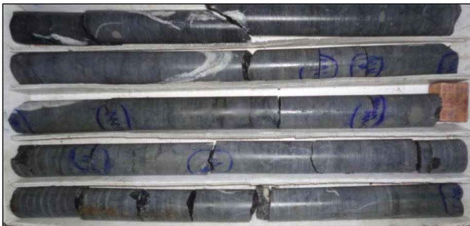
**Figura 4.30** Calculando el RQD se obtiene un valor de 98.2%
