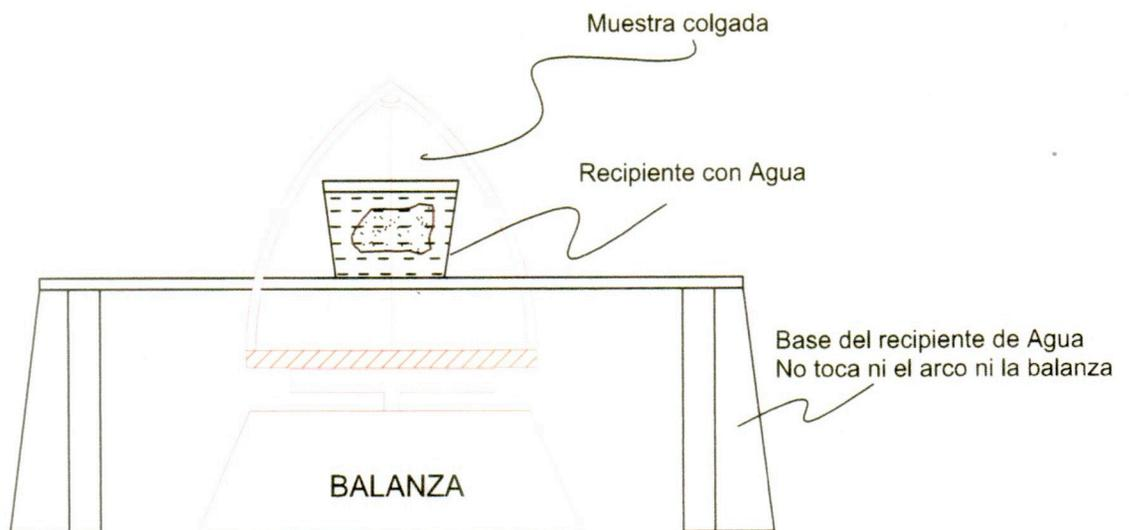
**Fig. C:** El segundo paso es pesar la muestra sumergida en agua (Pa), para ello se introduce la muestra en un recipiente con agua; el recipiente descansa sobre una base que no esta en contacto con la balanza.
