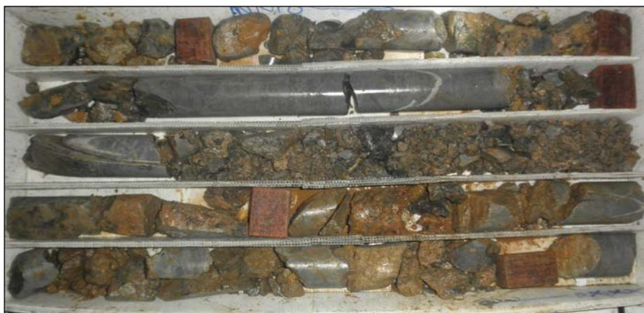
**Figura 4.25** Calculando el RQD se obtiene un valor de 12%
