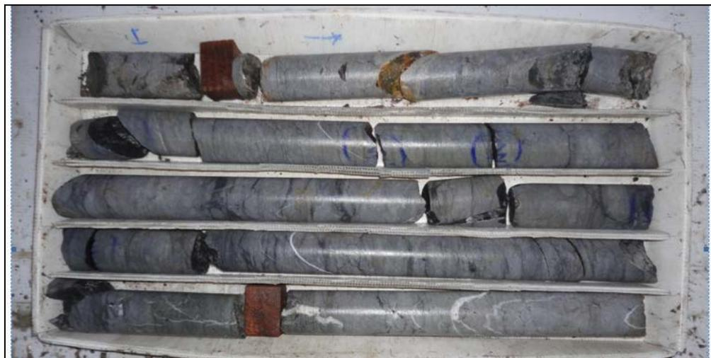
**Figura 4.28** Calculando el RQD se obtiene un valor de 90.8%
