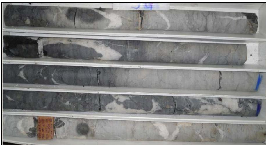
**Figura 4.31** Calculando el RQD se obtiene un valor de 100%
