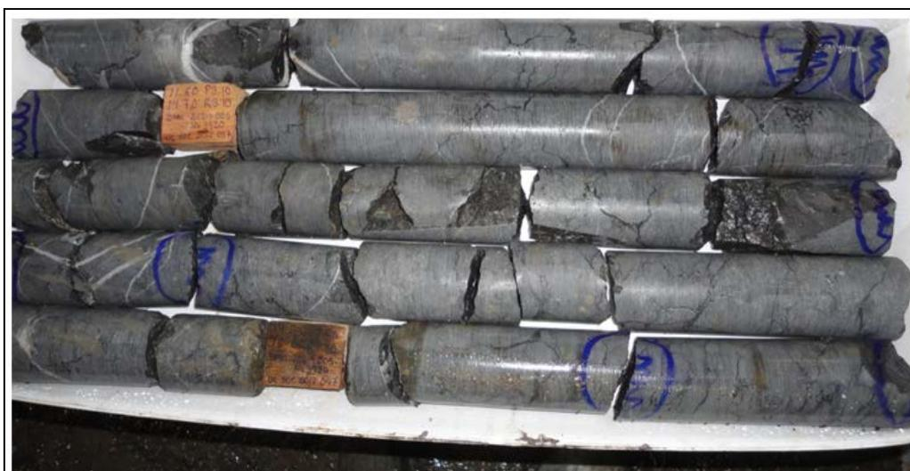
**Figura 4.27** Los círculos marcados en azul me indican que estos sufrieron rotura por el personal calculando el RQD se obtiene un valor de 87.1%
