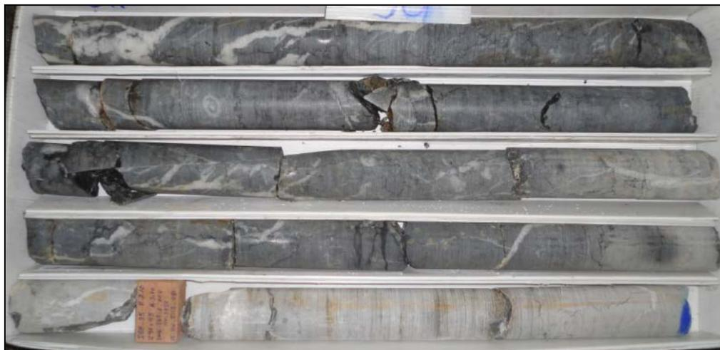
**Figura 4.32** Calculando el RQD se obtiene un valor de 94.4%
