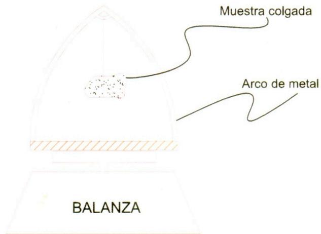
**Fig. B:** El primer paso para medir la gravedad específica, es pesar la muestra colgada de un arco que descansa en una balanza de precisión (Ps); previamente se gradúa la balanza a "0"gr. con el arco de encima.
