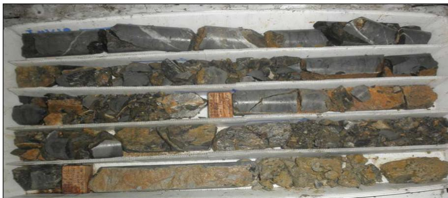
**Figura 4.24** Calculando el RQD se obtiene un valor de 22%
