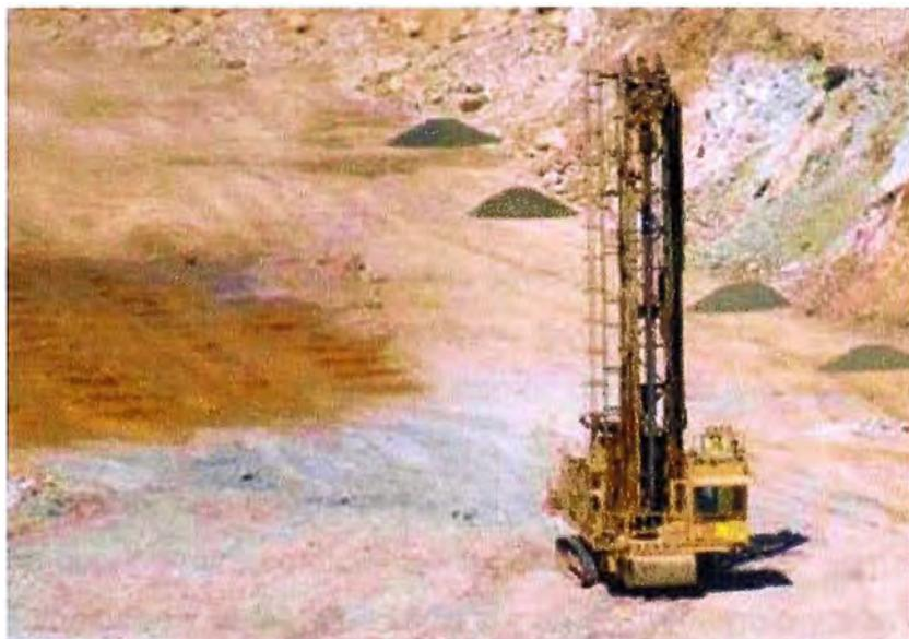
**Fig.1.6** Máquinas Perforadoras
