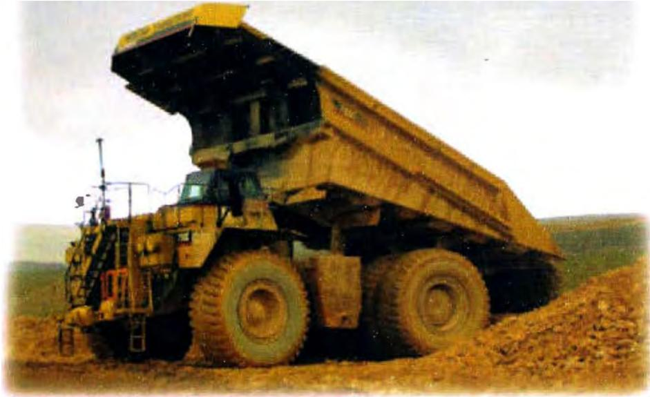
**Fig.1.8** Formando la pila de lixiviación
