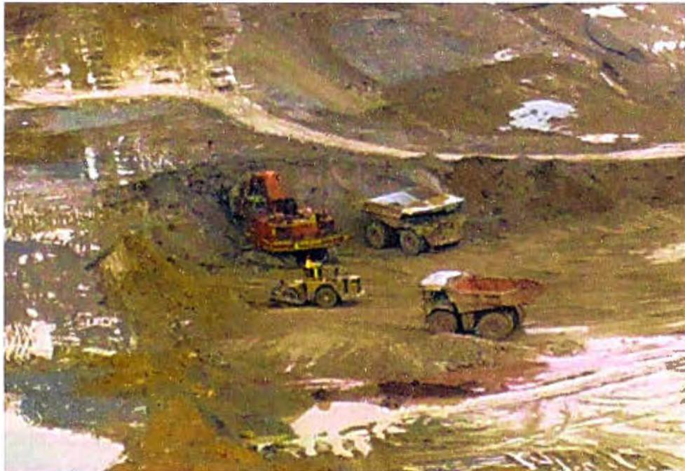
Fig.1.7 Palas gigantes cargando material fragmentado
