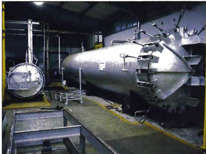
Figura N° 3.9. Autoclaves para vulcanizado de estructuras.
