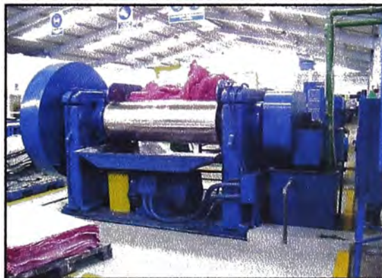
Figura N° 3.3. Molino (Mezcla, Aceleración ó reprocesamiento del caucho).
