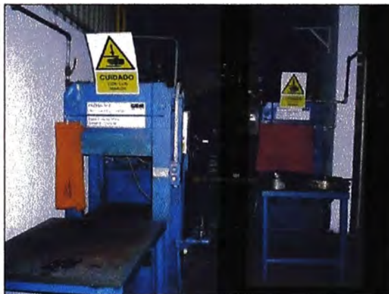
Figura N° 3.8. Prensas pequeñas neumáticas a vapor.
