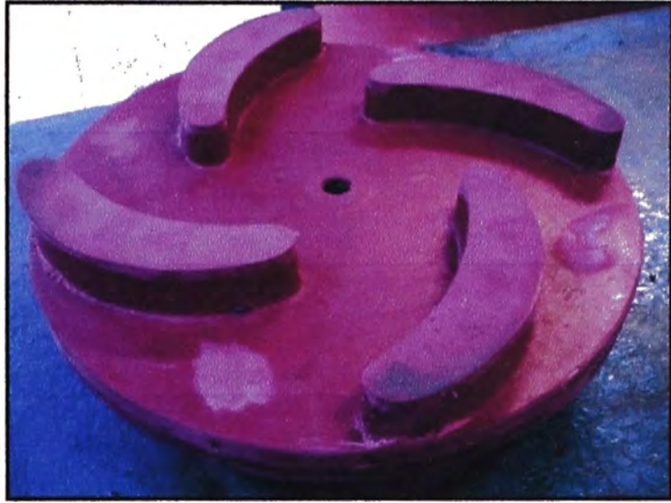
Figura N° 4.13. Impulsor revestido para bombas de pulpa minera.
