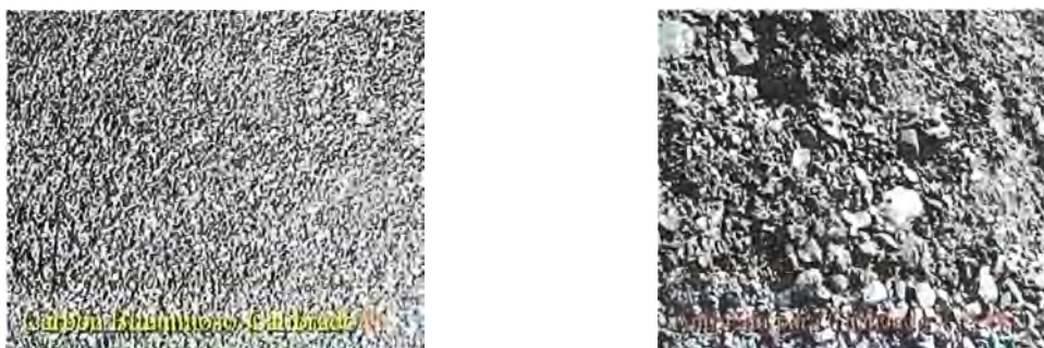
Figura 2.16: Carbón bituminoso calibrado y antracita para chancado
