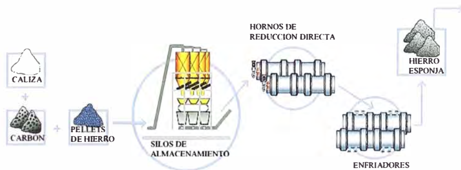
Figura 2.14: Esquema del proceso SL/RN
