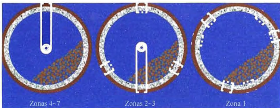
Figura : 2.22 Sección transversal del horno rotatorio
