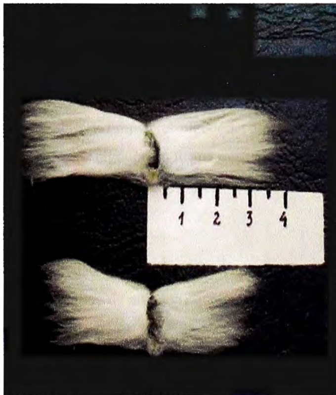
Fig.2.Fibra extralarga (Pima) en la parte superior y Fibra larga (Tangüis) en la parte inferior
