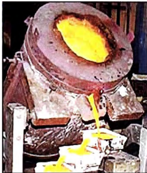
Figura I-8. Obtención de Oro como subproducto de fundición. [8]
