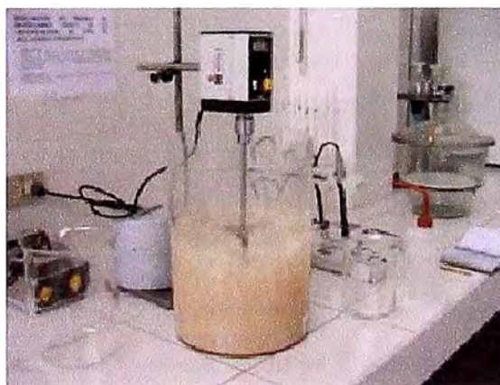
Figura II-11. Carga del complejo Au-CN sobre Resina. [22]
