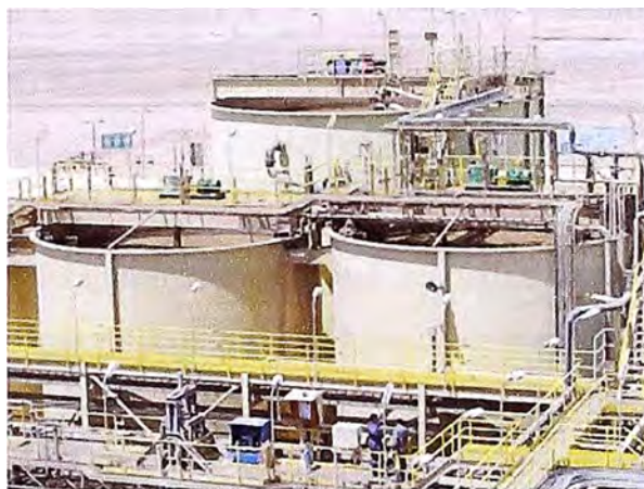
Figura II-9. LIXIVIACION POR AGITACION, para leyes mayores a 8 g/TM [20]
