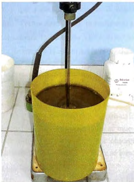
Figura IV-8. Reactor de lixiviación para determinación de parámetros óptimos de operación.
