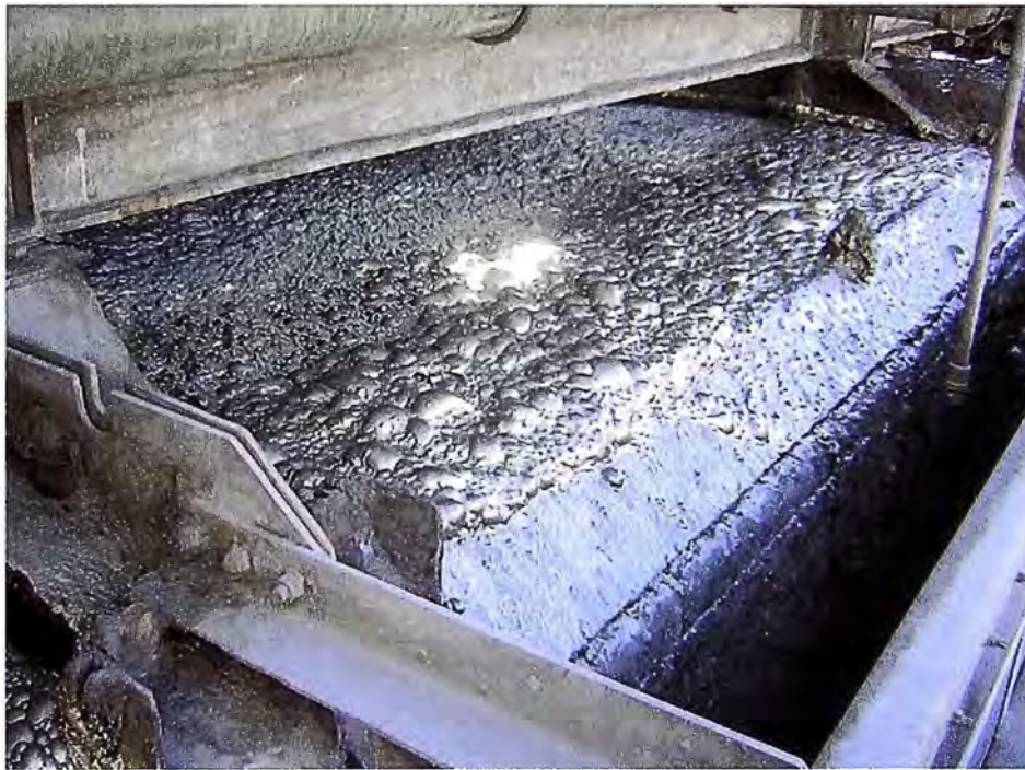
Figura II-5. Celda de Flotación [16]
