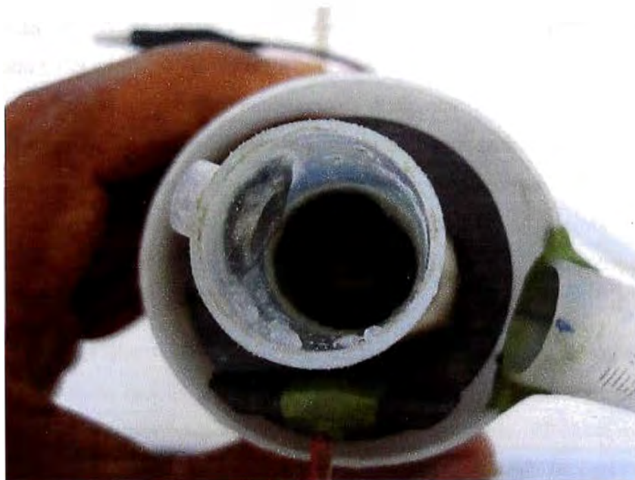
Figura IV-5. Estructura del reactor electroquímico
