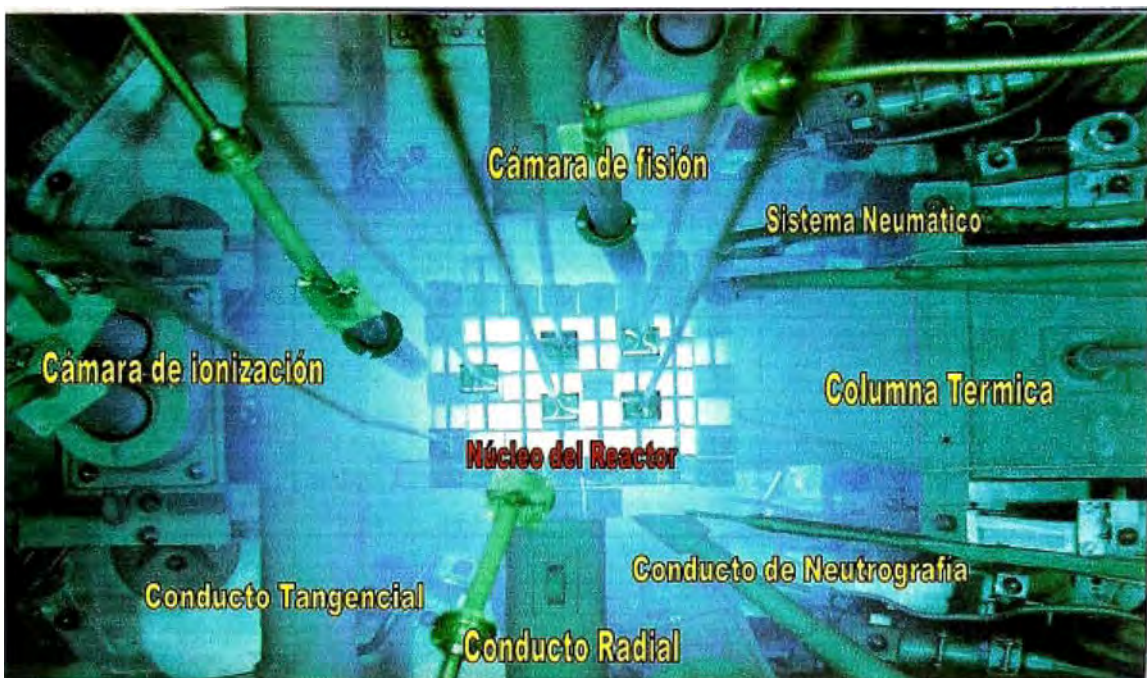
Figura N° 2.2: Componentes del núcleo del Reactor RP-10
