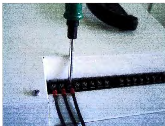
Figura 4.3. Conectar los cables de los electrodos al TRE
