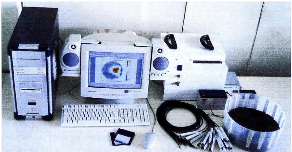
Figura 4.1 fotografía del Tomógrafo de resistividad eléctrica
