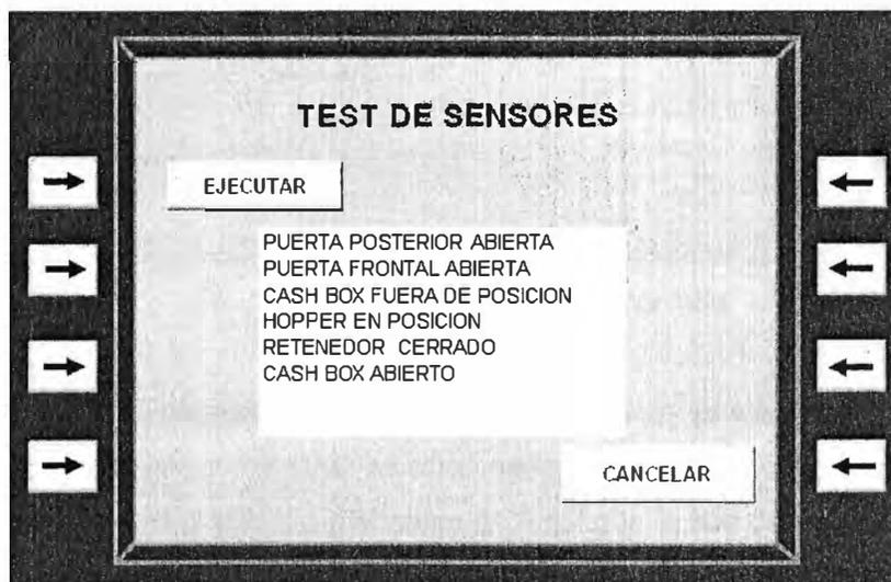
Fig. 3.42 Pantalla de test de sensores
