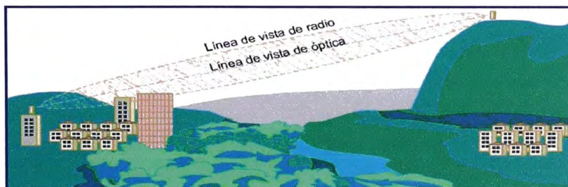
Fig. 1.2.2.b línea de vista (radio) vs línea de visual (óptica)
