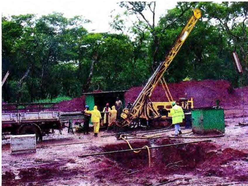
**Fig 2.9 Perforación Diamantina y Circulación Reversa**
