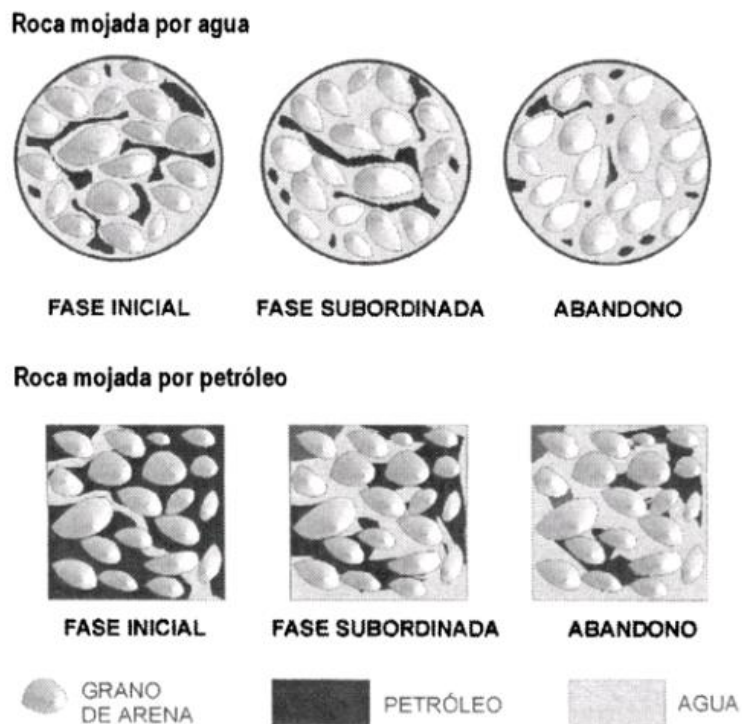
Fig. 8 Distribución de fluidos en una inyección de agua. (Según Craig)
