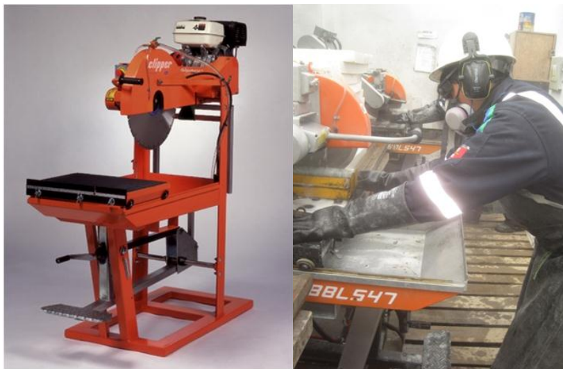
Figura 4.1. Izquierda: Cortadora eléctrica de testigos, Derecha: personal técnico realizando el corte de los testigos.
