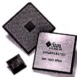
Figura 2.1 Chip de Microprocesador UltraSPARC IIIi
