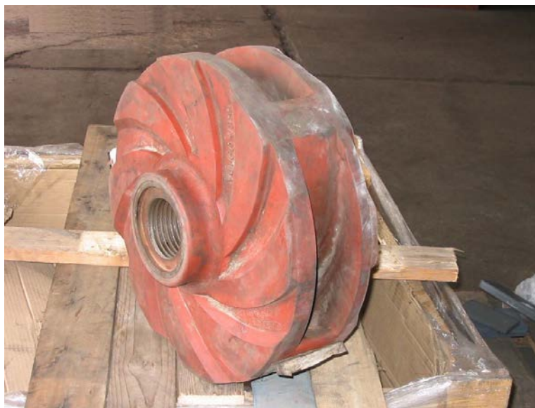
Figura N° 1.6.- Impulsor cerrado, se aprecia la rosca y el detalle de la cara posterior.
