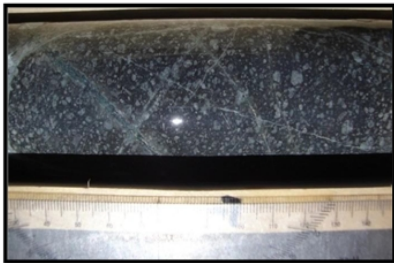
Figura 18. Pórfido Andesítico con fenocristales de plagioclasa, venillas de clorita magnetita.
