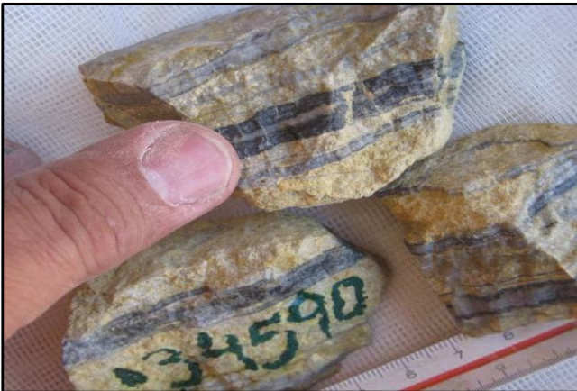
Figura 10. Venillas de cuarzo-enargita
