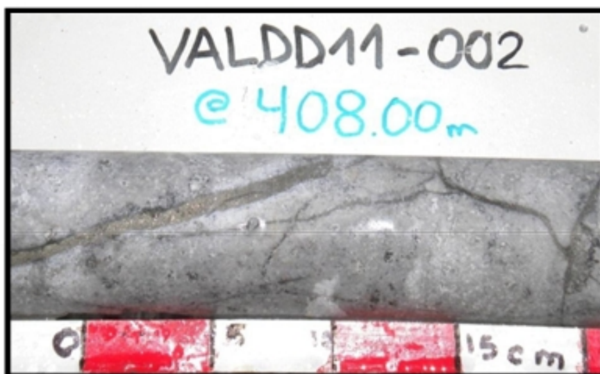
Figura 13. Ignimbrita Riolítica con venilla de pirita-enargita milimétrica.
