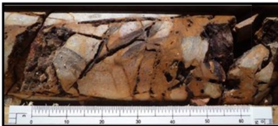
Figura 24. Canal de Brecha craquelada, con abundante OxFe a los 13.50 mts.
