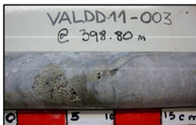
Figura 15. Ignimbrita Rioltica silicificada con venilla de cuarzo-pirita-enargita.
