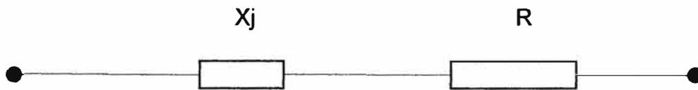
**Fig. 4.4 Circuito equivalente para el cálculo de Cortocircuito**
