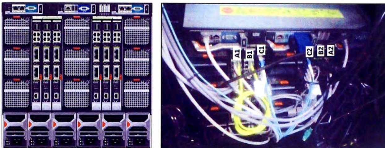
**Fig. 3.17** Ubicación de módulos fabric switch del chasis Dell.
