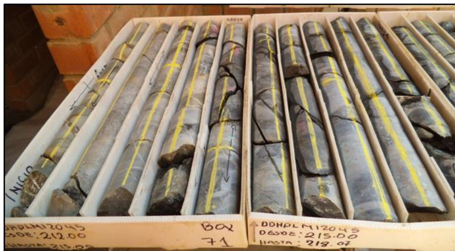
Figura 4.2: Líneas de corte en el testigo pintadas de amarillo.
