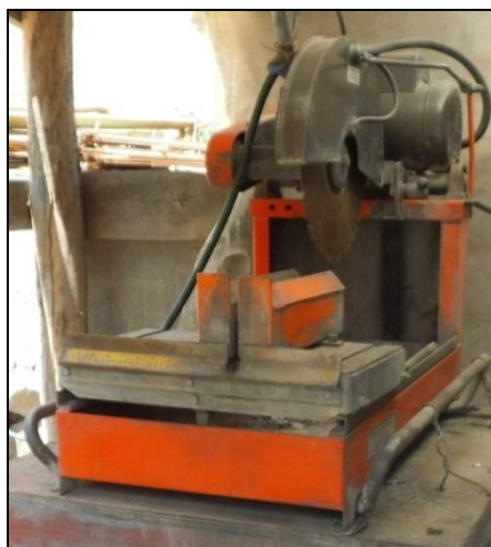
Figura 3.5: Máquina cortadora de disco diamantado
