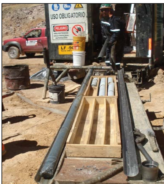
Figura 3.2: Colocado de sondaje en cajas de testigo
