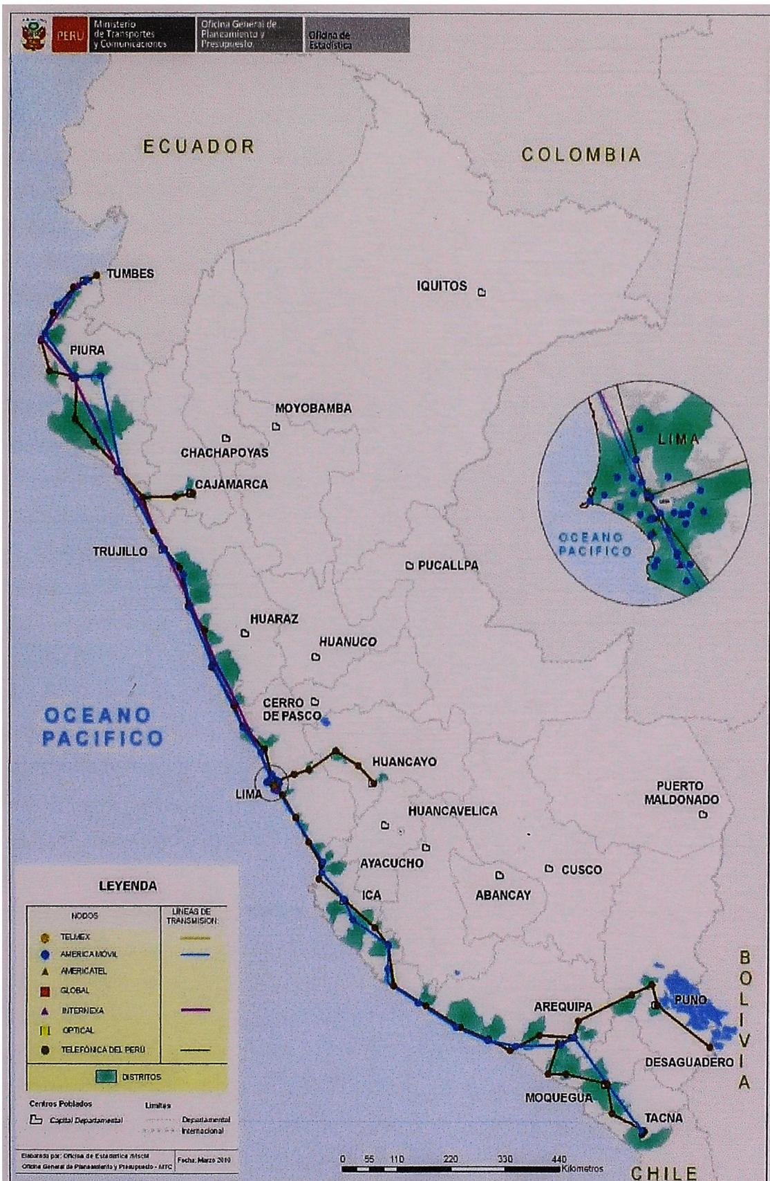
Figura 1.1 Red Nacional de fibra óptica existente – fuente MTC
