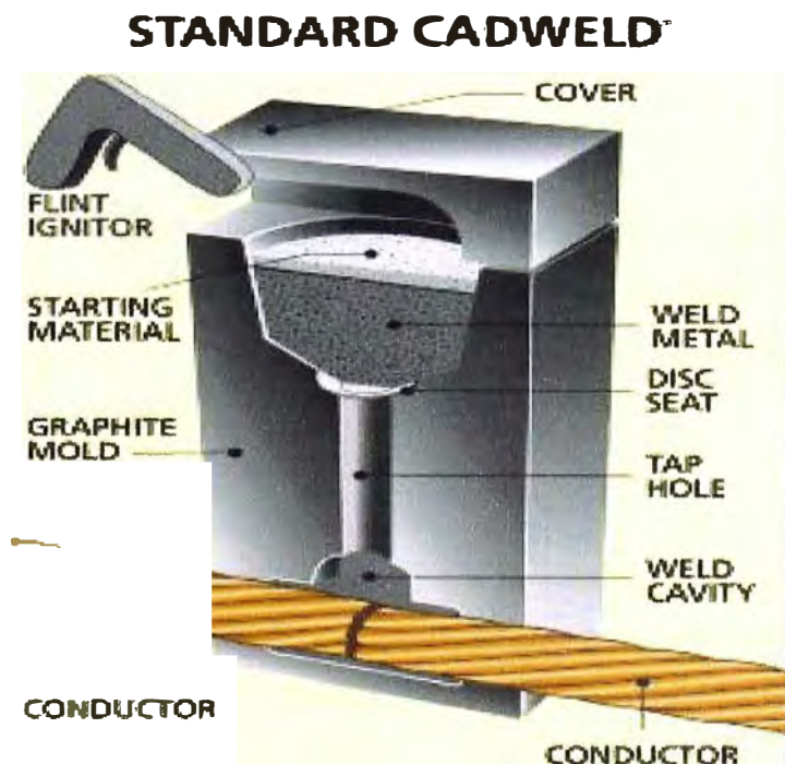
Fig. 4.17 esquema de molde para soldadura exotérmica [8]
