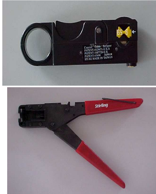
Fig. 4.28 Herramientas de telecable
