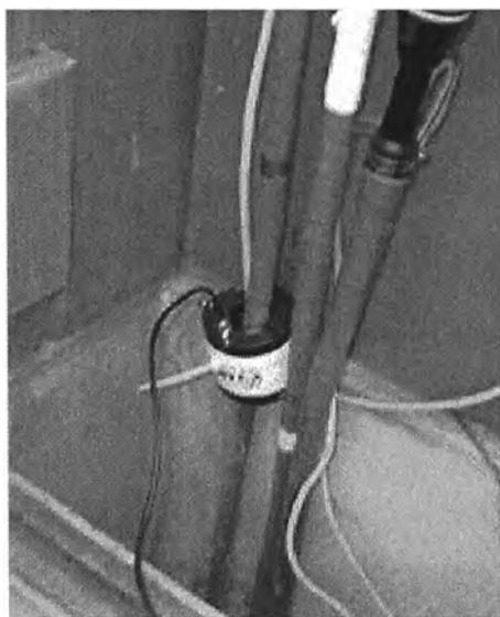
**Fig. 5.10** SED Compacta con Acoplador Inductivo
