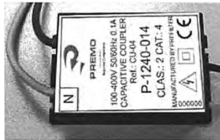
**Fig. 2.19** Acoplador Capacitivo P-1240-014
