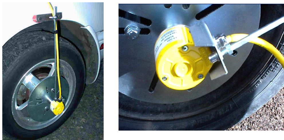
Figura 2.9: Encoder para medición de Velocidad del vehículo montado en vehículo
