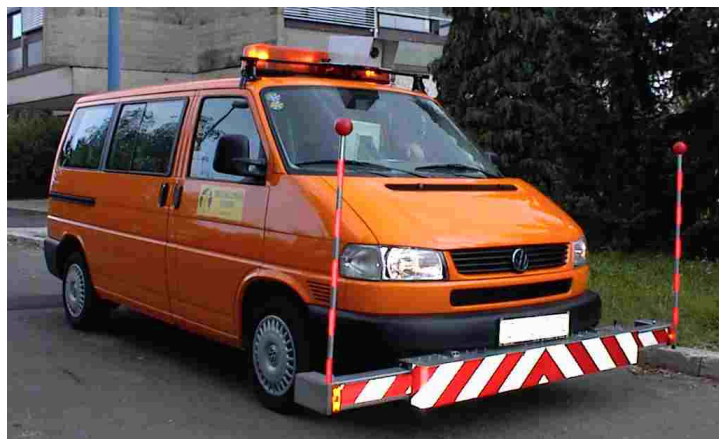
Figura 2.12: Perfilómetro láser montado en el vehículo.
