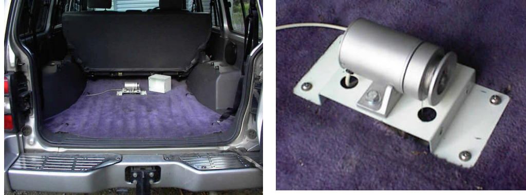
Figura 2.7: Encoder del Bump Integrator ensamblado en el vehículo.
