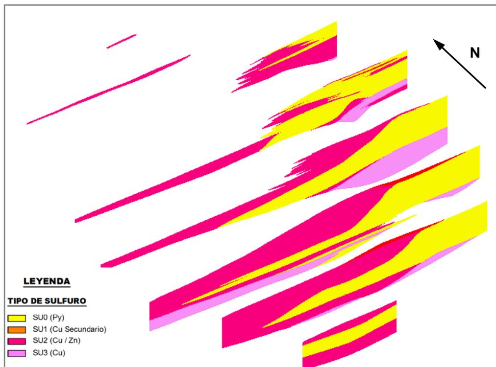
Figura 3.1 Secciones Geológicas por tipo de Sulfuro.
