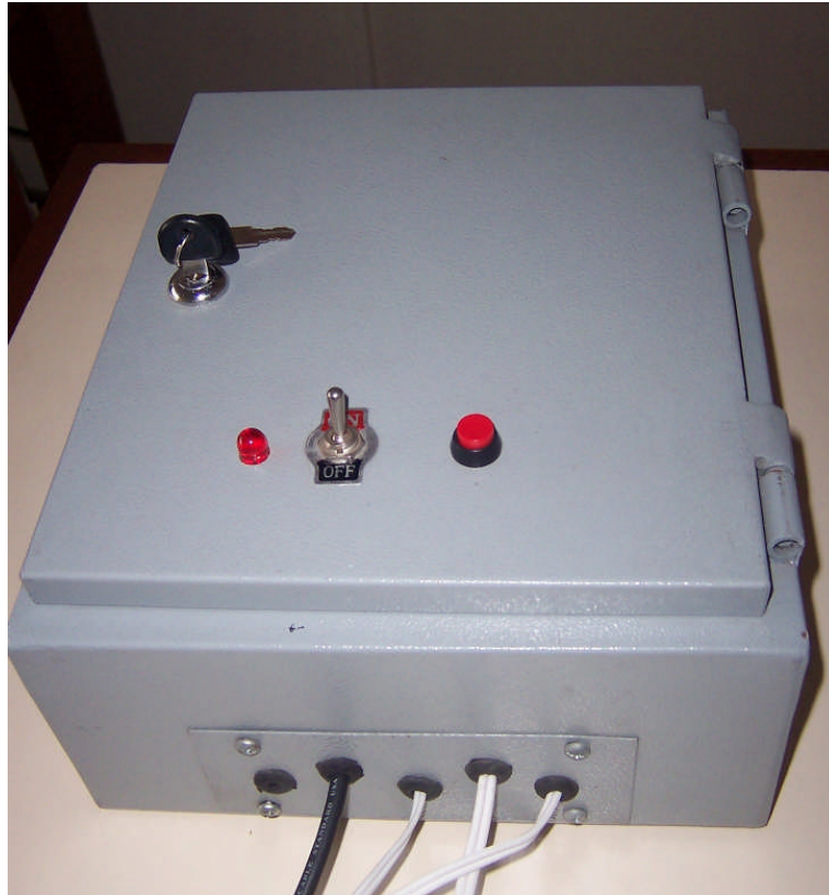
Fig. 2.13 Caja de control de velocidad y detección de papa
