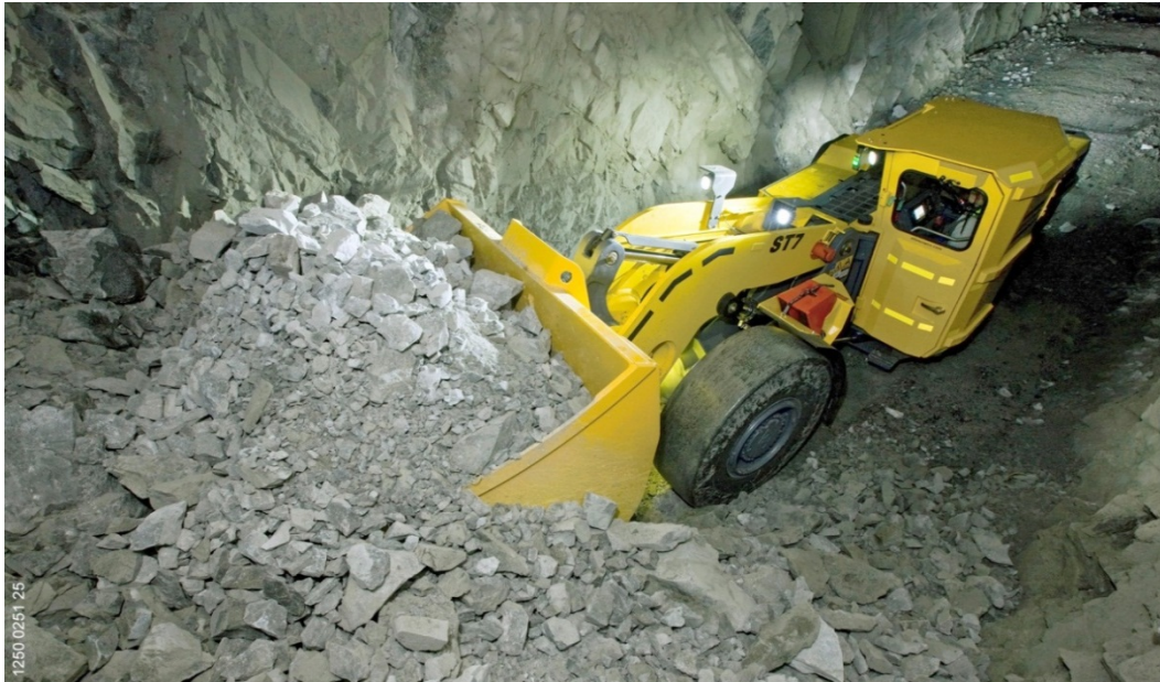
FIGURA 11: Scoop st 7 de 3.5 y 3 limpiando un frente – fuente archivo SIMSA.
