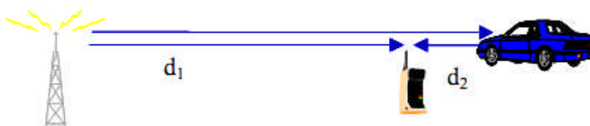
Figura 3.14 Ejemplo de escenario de propagación de dos rayos simplificado
