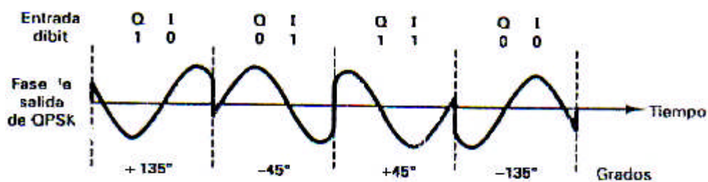
Figura 1.10 Relación de la fase de salida versus tiempo para un modulador QPSK.
