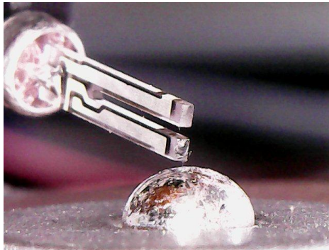
Figura 60. Fotografía de la sonda de diapasón en contacto con una gota de mercurio
