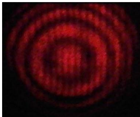
Figura 13. Franjas de interferencia de Michelson producidas por el desplazamiento del piezoeléctrico.
