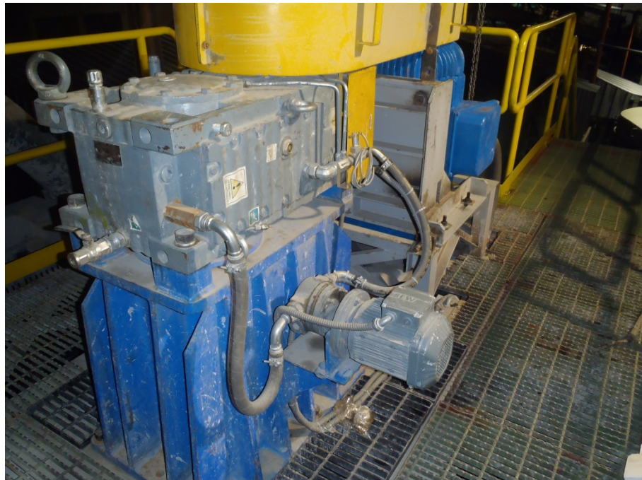
Figura 22: Reductor marca Sew Eurodrive
