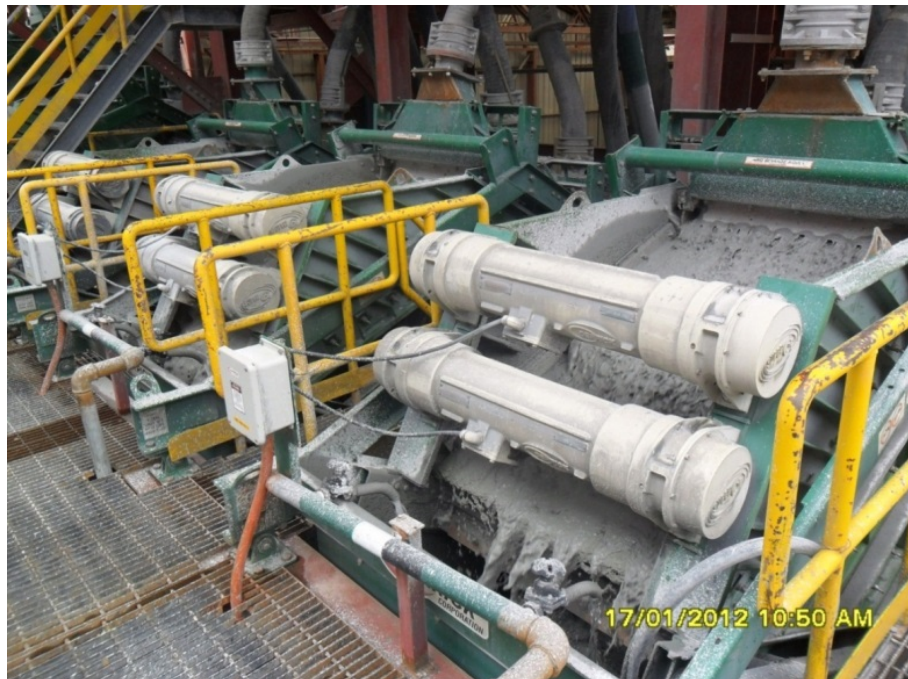
Figura 17: Zaranda de alta frecuencia en plena operación
