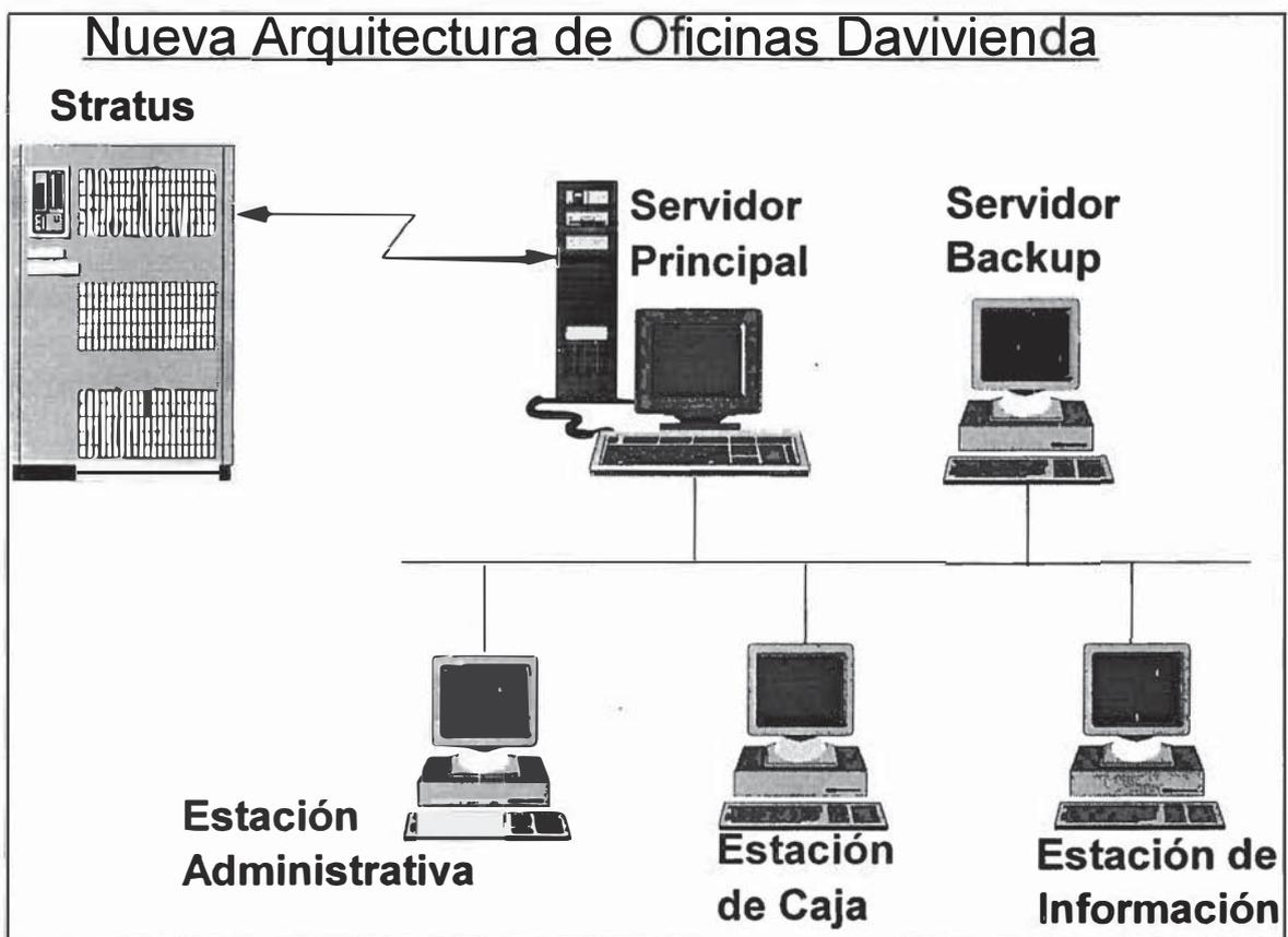
**SERVIDOR PRINCIPAL:** Se trata de un IBM PC 320 que ofrece servicios de base de datos, disco e impresión.
