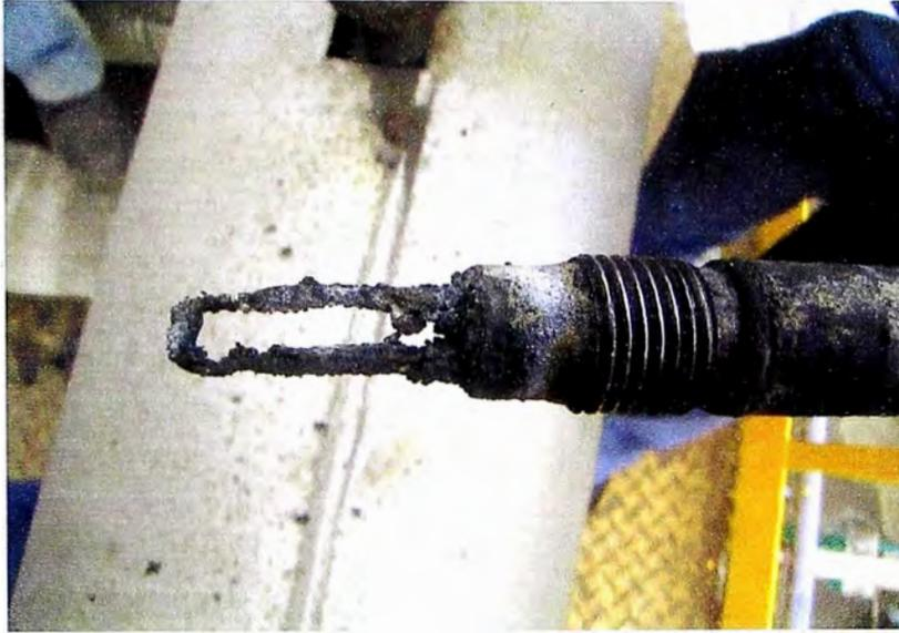
**Foto N° 5a : Probetas de Corrosión Usadas en el Sistema de Tope de la UDP**
