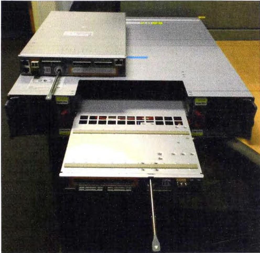
**Figura 3.10** Controladores FC del sistema de almacenamiento
