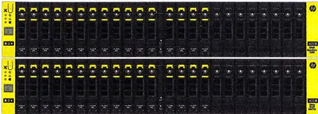
**Figura 3.3** Sistema de almacenamiento HP 3PAR StoreServ 7200 (10TB)
